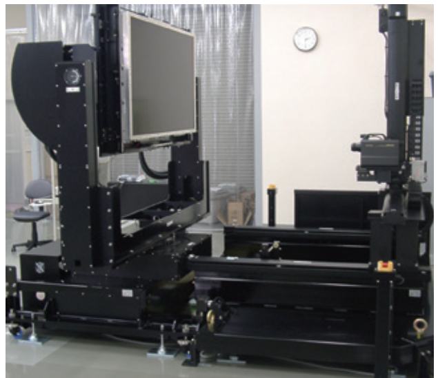
液晶パネルの輝度・コントラスト等の光学特性を測定する装置
